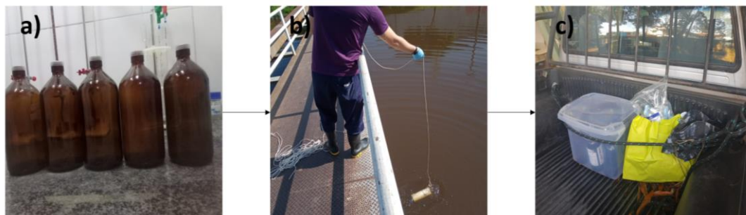
Figura 15: Etapas do processo de coleta de amostras de água: a) Frascos âmbar de 1L utilizados na coleta previamente esterilizados. b) Coleta de água. c) Armazenamento das amostras para serem levadas ao laboratório.
