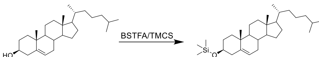
Figura 10: Reação de derivatização do colesterol através da substituição do hidrogênio da hidroxila (-OH) pelo grupo trimetil-silícico (-Si(CH 3 ) 3 ) do reagentes N,O-bis(trimetil-silil-trifluoroacetamida)/trimetil-cloro-silano (9:1) (BSTFA/TCMS).
