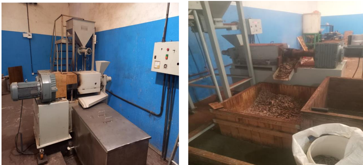
Figura 2. Maquinário responsável pela trituração da amêndoa do tucumã, extração do óleo e separação do resíduo (torta). Fonte: Arquivo pessoal.
