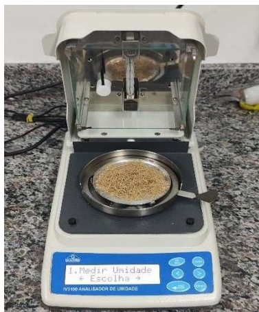
Figura 18: Determinação da umidade da palha de milho em analisador de umidade infravermelho
