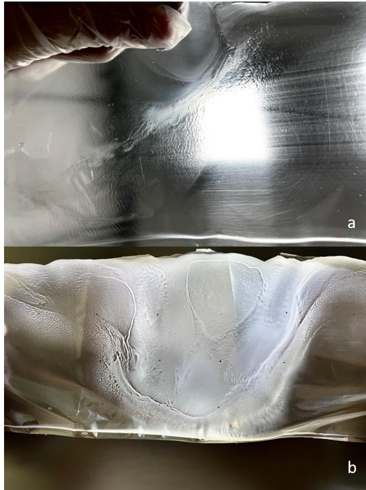
Figura 15 - Defeitos na superfície do filme formado em T:100°C e V:2400 r.p.m. (a); Secagem heterogênea do filme formado em T:110°C e V:2800 r.p.m. (b).
