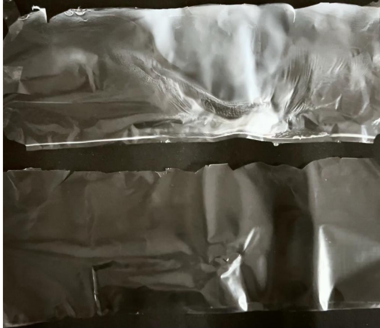
Figura 16 – Filme formado em T: 100°C, V:2400 r.p.m. e t: 30 min (superior); T: 40°C, V:2400 r.p.m. e t: 3h45min (inferior).
