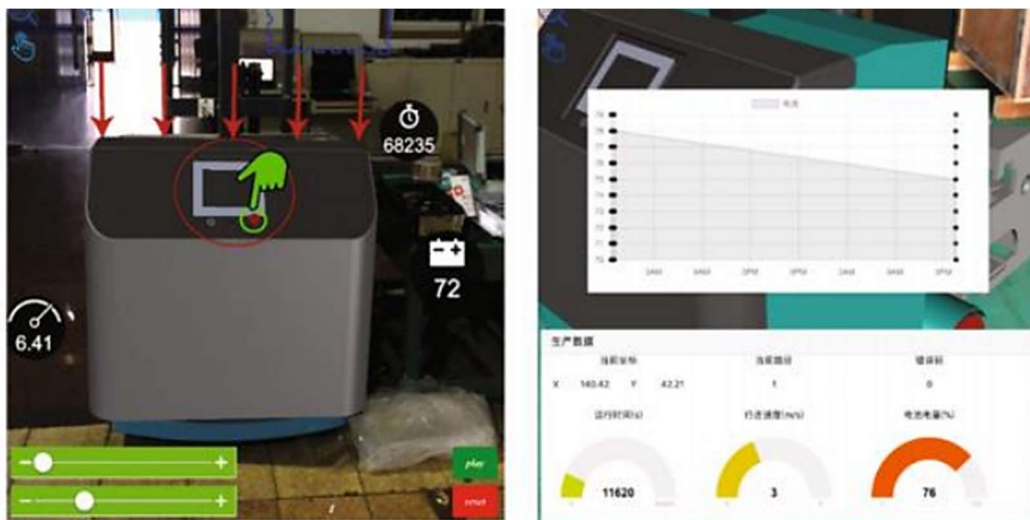
Figura 16 - Monitoramento de Veículo Guiado Automatizado com RA. Fonte: [28]
