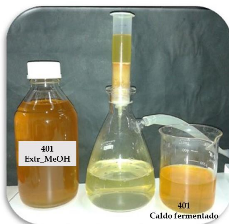
Figura 12. Sistema de extração em fase sólida.
