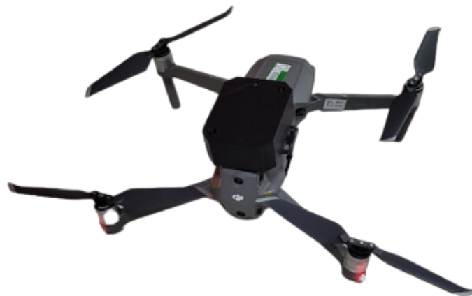
Figura 14: Nó coordenador móvel composto de uma Raspberry Pi 3 Model B afixada em um Drone modelo DJI Mavic 2 Zoom.
