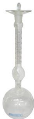
Figura 9 – Frasco de Le Chatelier para determinação da massa específica – Fonte: (Próprio autor, 2022).
