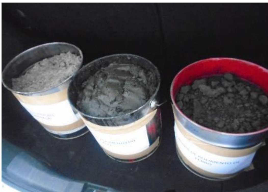
Figura 3 – Segregação dos tipos de borra: Cromo, fosfato e polimento, respectivamente. – Fonte: (Empresa da indústria automotiva, 2021).
