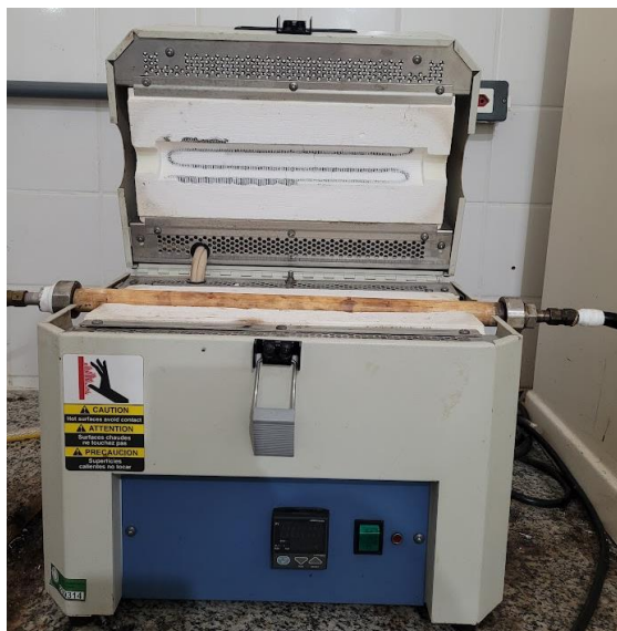
Figura 7. Forno tubular utilizado no processo de torrefação.
