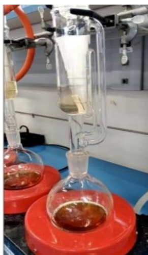
Figura 16. Sistema para análise do teor de extrativos nas amostras de E. precatória , A. aculeatum e P. cupana (Próprio Autor, 2021).
