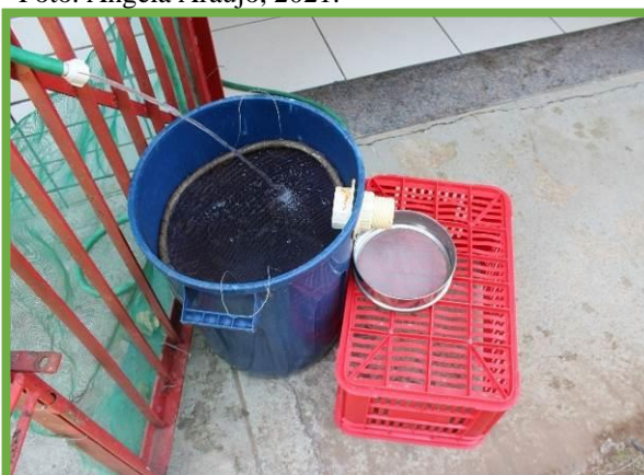
Figura 25. Flotadeira com as peneiras e as malhas em diferentes espaçamentos. Foto. Angela Araújo, 2021.
