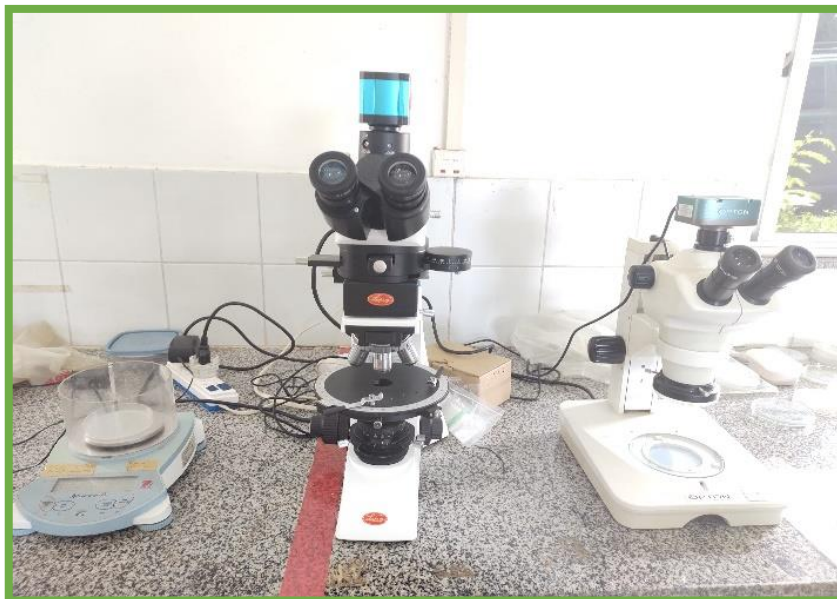
Figura 31. Instrumentos auxiliares que foram utilizados na medição de peso, visualização e identificação das estruturas e das formas de organização dos macrovegetais. Da esquerda para direita balança de precisão, ao meio microscópio trinocular e na sequência o estereomicroscópio trinocular. Fotos. Angela Araújo, 2022.
