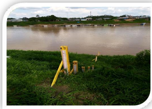
Figura 06: Régua fluviométrica as margens esquerdam do rio Tarauacá
