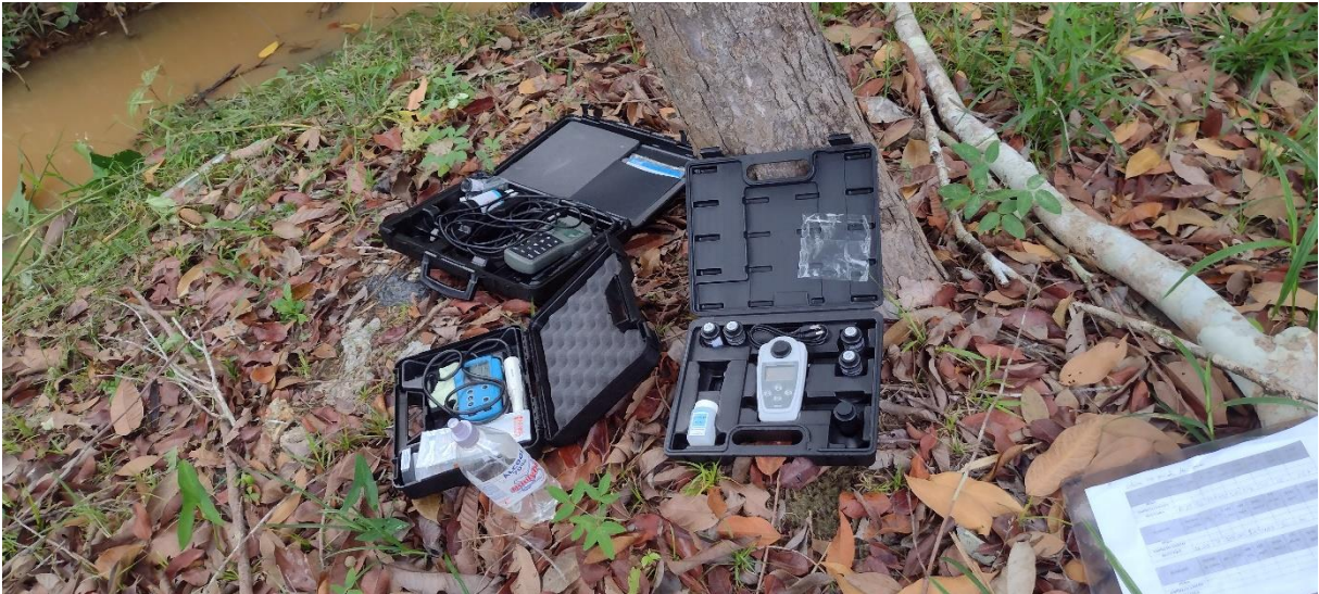
Figura 15: Medidor Portátil com a utilização de medidores multiparâmetros e turbidímetro portátil.
