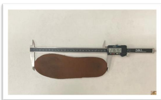
Imagem 3 – Medição do comprimento da palmilha
