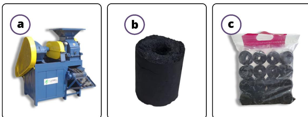
Figura 32 - Processamento do resíduo do açaí: a) Britadeira; b) Briquete; c) Briquetes para comercialização
