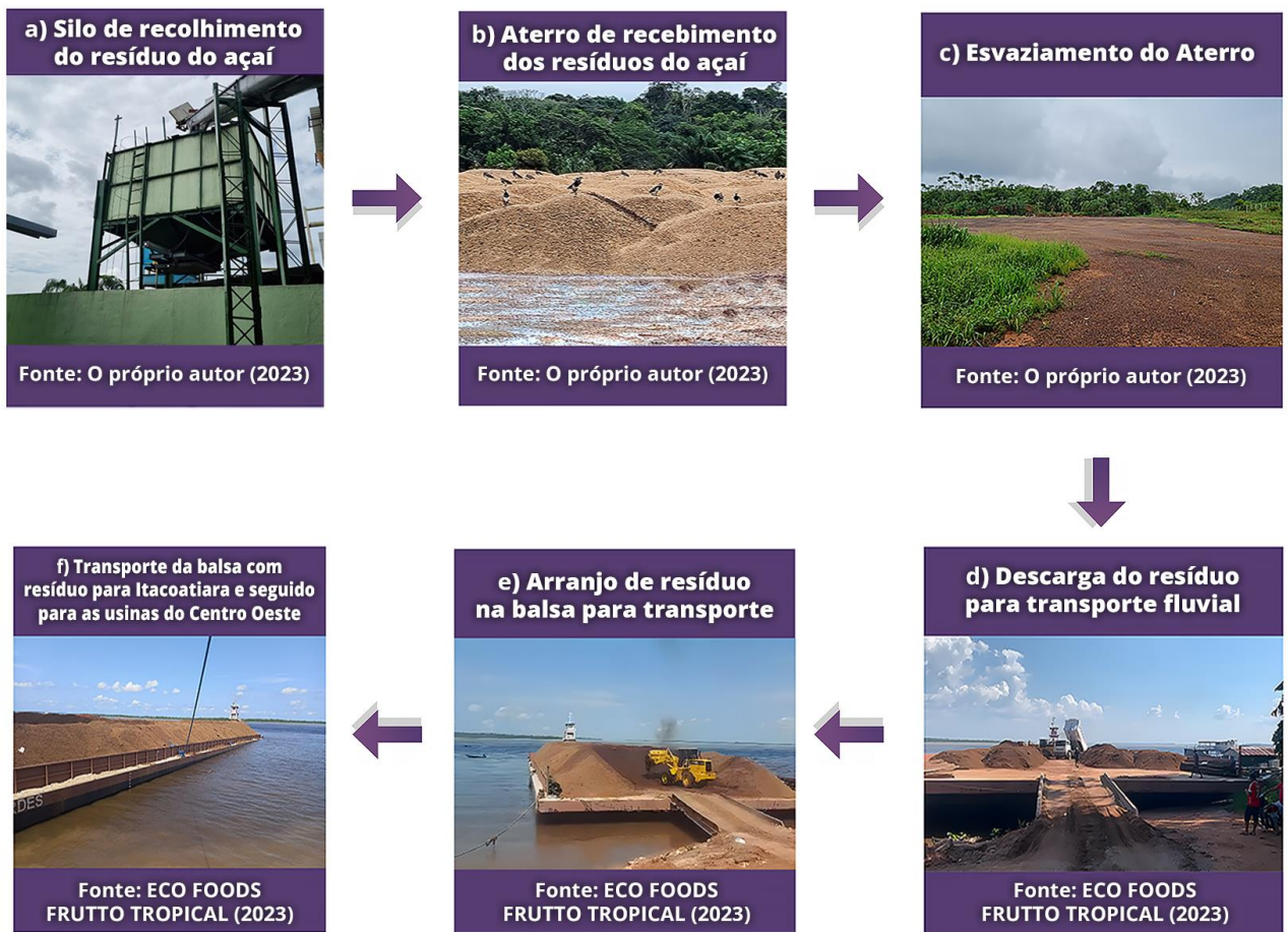
Figura 31 - Fluxograma do processamento do açai ( Euterpe precatoria Mart.)
