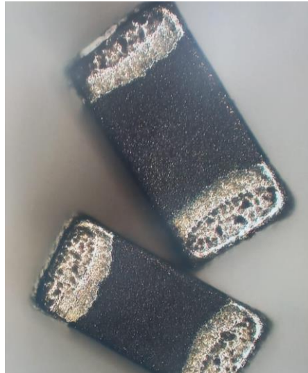
Figura 11 – Capacitor com oxidação
