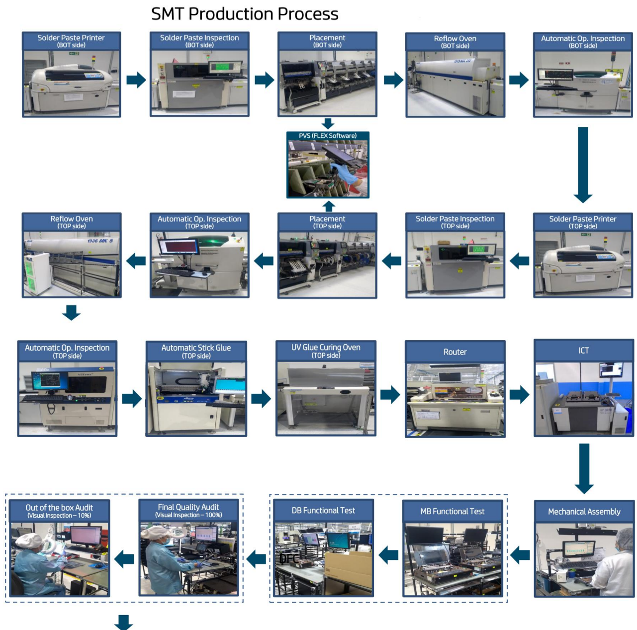
Figura 18 – Processo produtivo SMT
