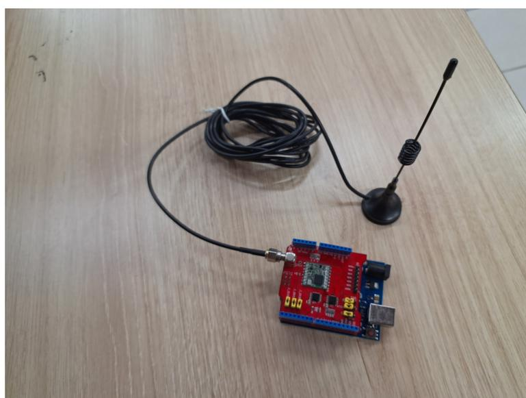
Figura 18 – Módulo estação de transmissão, com antena conectada.
