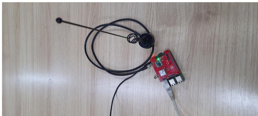
Figura 17 – Módulo *gateway*, com antena conectada.
