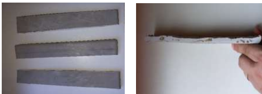
Figura 17 - apresentação dos corpos-de-prova para o ensaio de flexão
