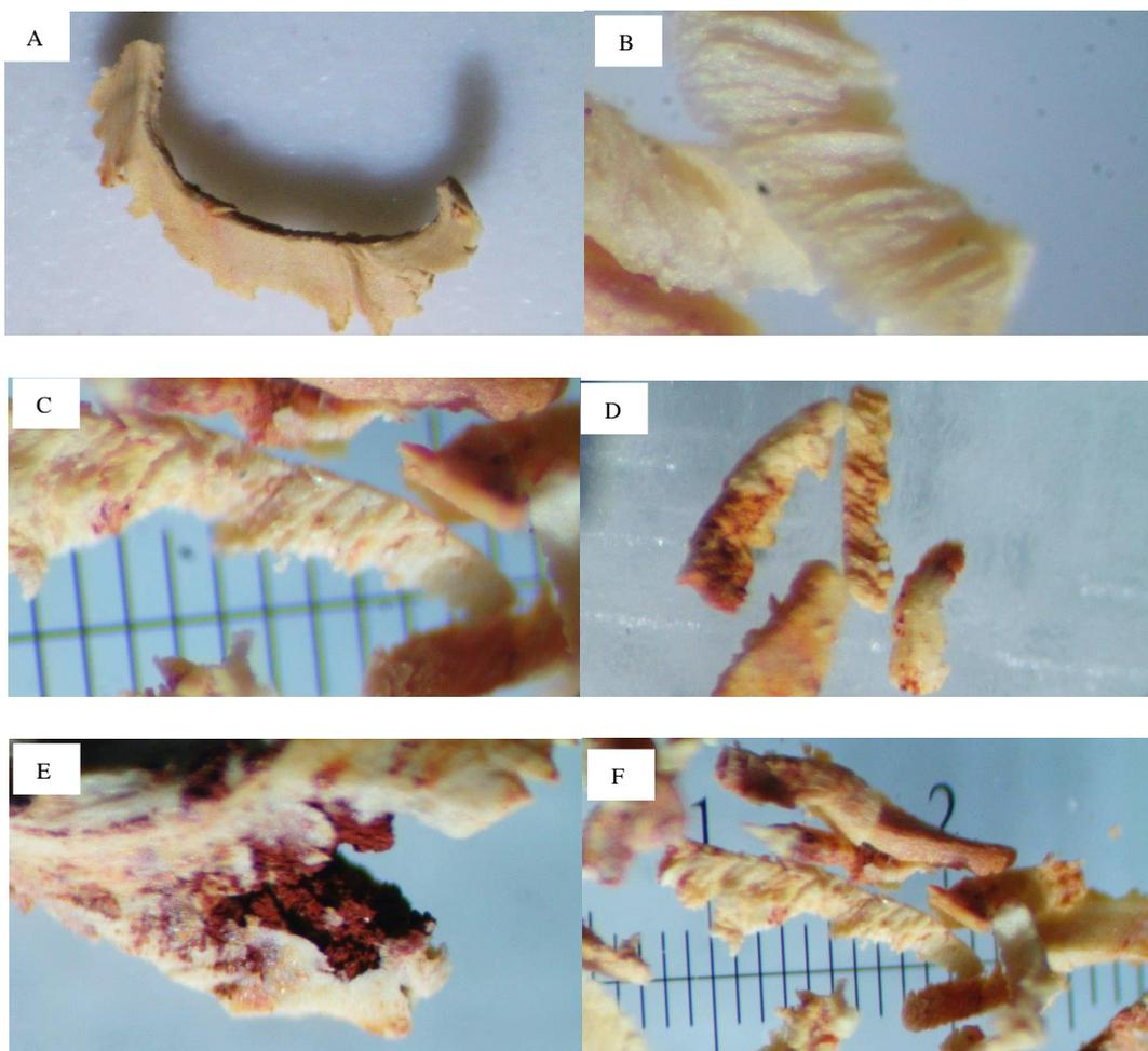
Figura 16. Fotomicrografia das amostras do argilomineral em diferentes granulometrias preparadas para ser utilizadas como leito filtrante.
