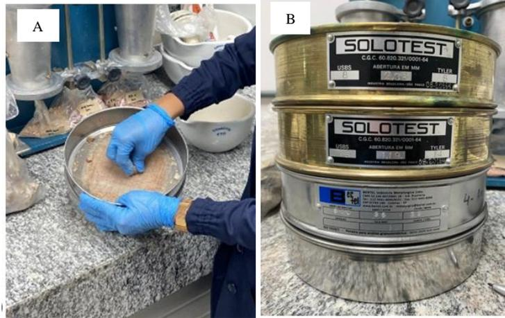
Figura 7. (A) Confeção dos fiapos de argila sob fricção e (B) peneiras granulométricas usadas para moldar as argilas.
