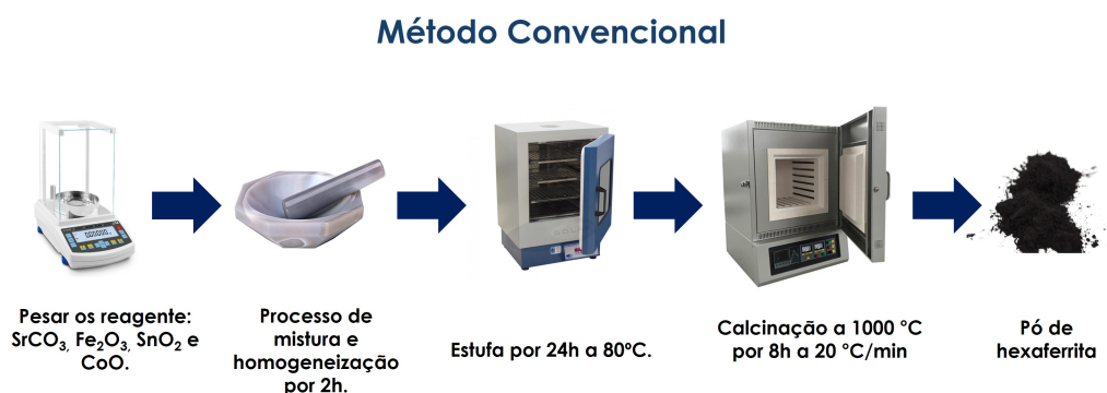
Figura 3.1: Esquema ilustrativo do Método de Reação no Estado Sólido.
