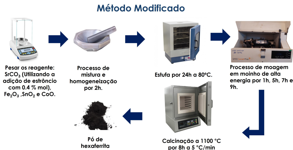
Figura 3.3: Esquema ilustrativo do método modificado.
