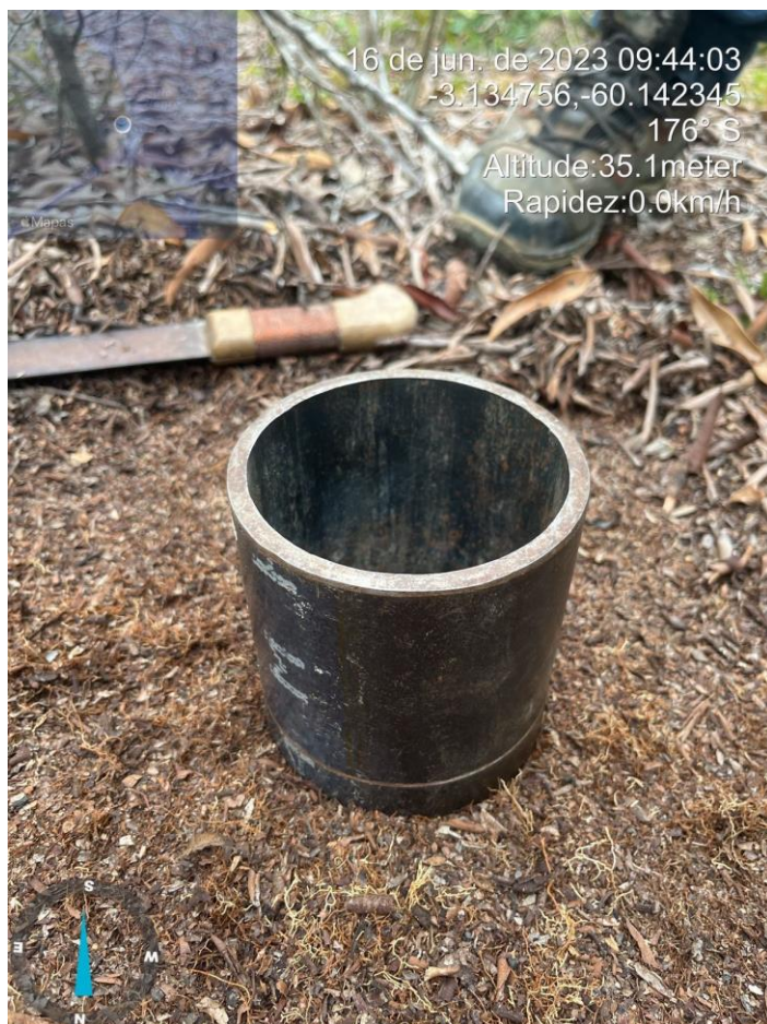
Figura 20 — Teste de infiltração na falésia 5
