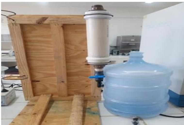
Inicialmente foi produzido uma solução de 5 litros como o limite máximo de absorbância de 2.5 a. u., posteriormente no tanque abriu-se a vazão, depois as alíquotas foram retiradas de litro em litro de solução filtrada e suas absorbâncias foram observadas em varredura, até que todo líquido do tanque passasse pelo filtro.
