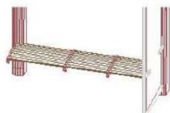
Banco com três assentos, sendo um deles com 70 cm de largura para obesos. Produzido em madeira plástica e sustentado por grapos de aço presos aos pilares central e direito do do abrigo.
