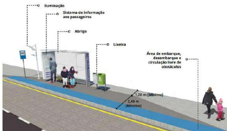
Figura 22 Características básicas para um a instalação de um abrigo em ponto de ônibus
