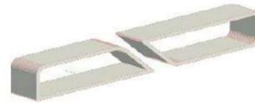
Banco de concreto armado, disposto sobre o solo. Preferencialmente pigmentado de branco durante sua produção. Utilizar selador acrílico para manter sua superfície impermeável. Pode ser utilizado de ambos os lados. Dimensões: 0,43 m x 0,45 (altura x profundidade); faces: 1,85 m e 1,20m de comprimento
