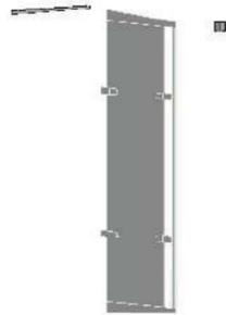
Proteção lateral em aço inoxidável e vidro de 0,40mm com película de proteção UV, fixada ao pilar direito do abrigo através de grampo de suporte.l.
