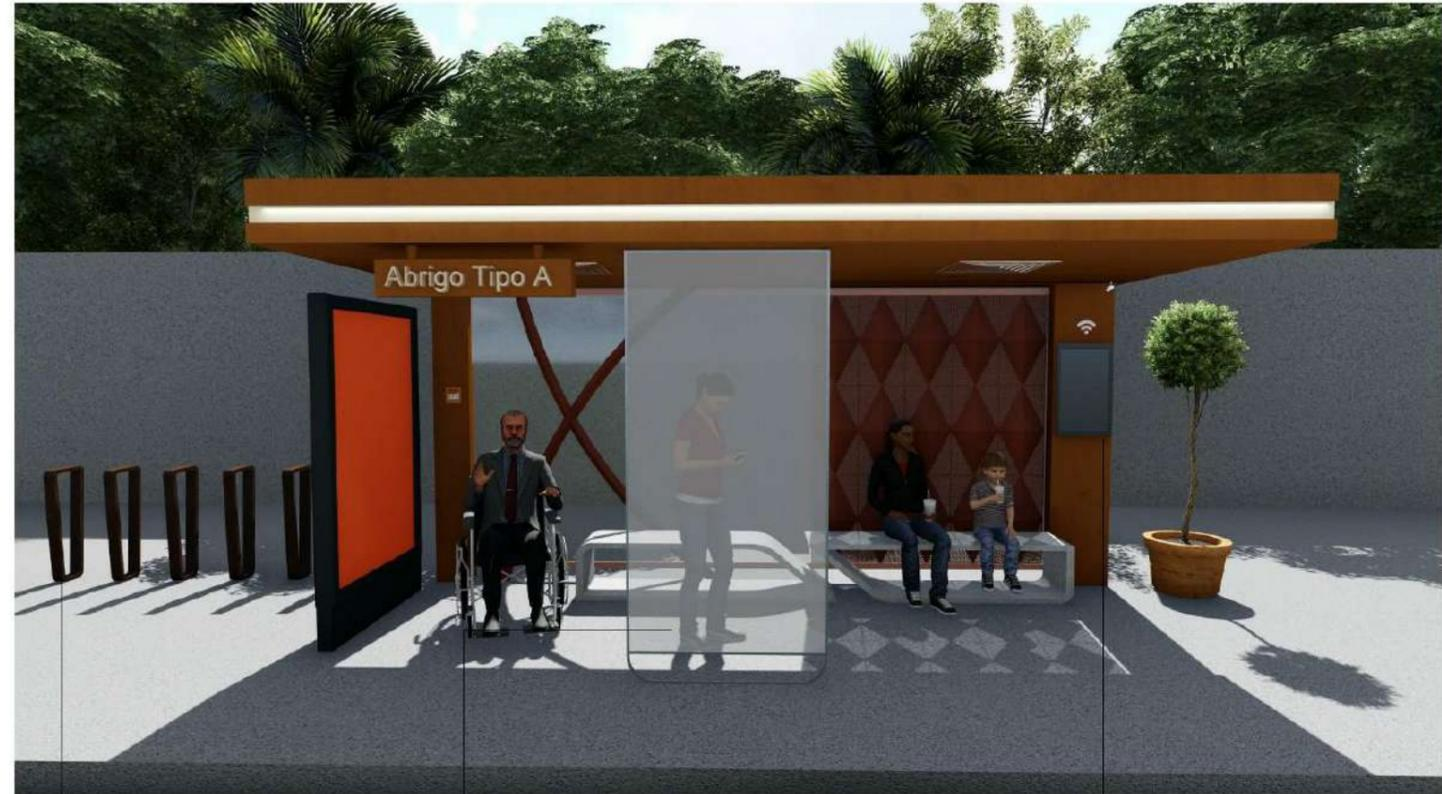
Bicicletário, em aço inoxidável e pintura epóxi. Deve possuir a mesma cor dos elementos 1 e 2.
