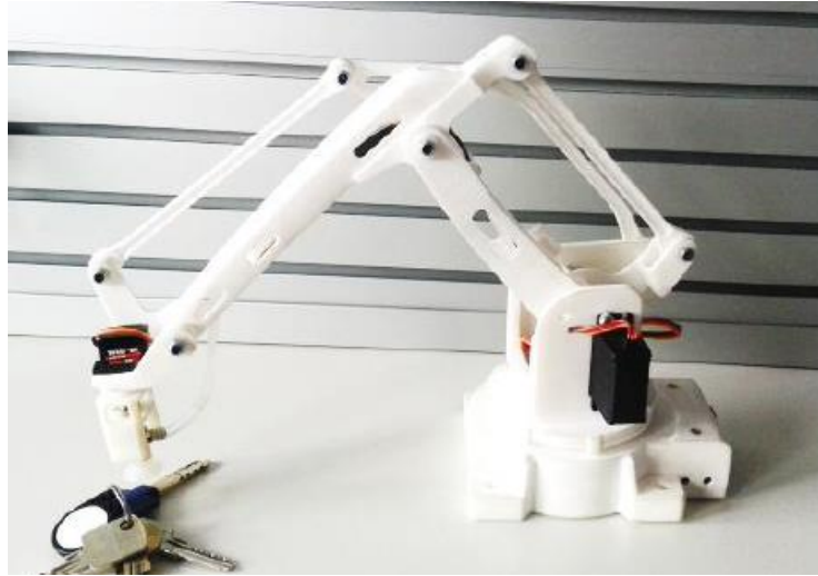
Figura 19 – Exemplo de protótipo com Impressão 3D.
