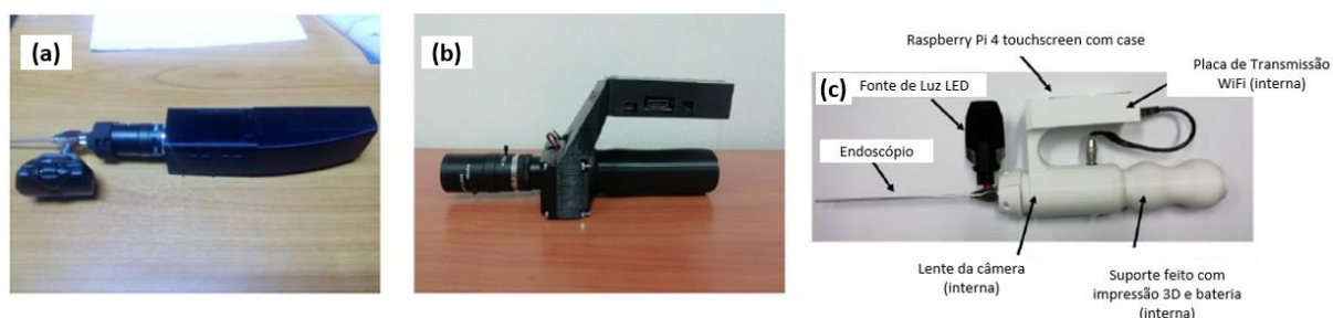
Figura 12 – Aplicação de DT em dispositivo de endoscopia. (a) Protótipo 1ª geração. (b) Protótipo 2ª geração. (c) Protótipo final.
