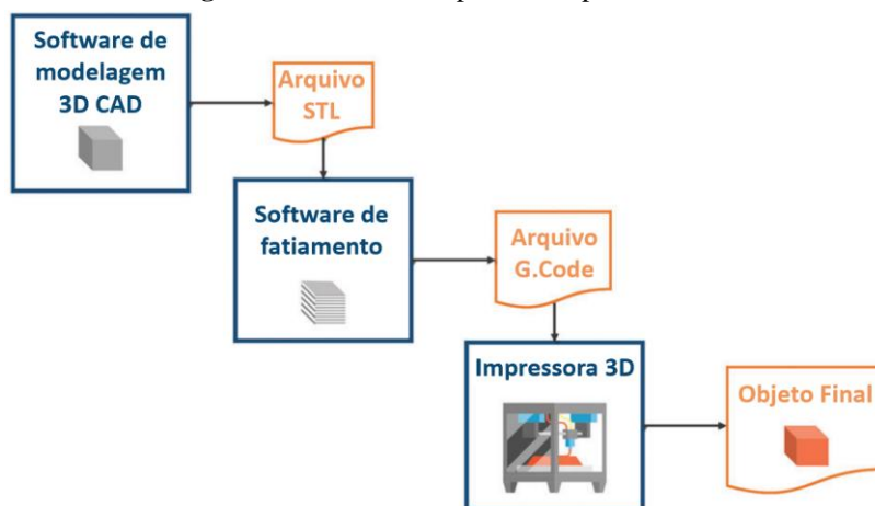
Figura 16 - Processo Típico de Impressão 3D.
