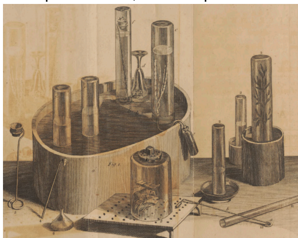
Figura 7 – “Cuba pneumática”, utilizada para coletar formas de ar.
