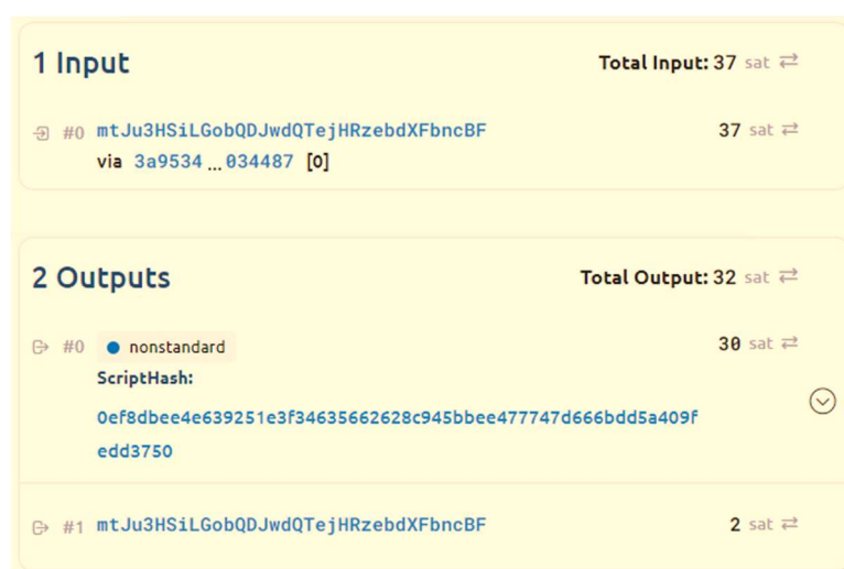
Figura 46 - Entradas e saídas da transação de criação do contrato. Fonte: A autora.
