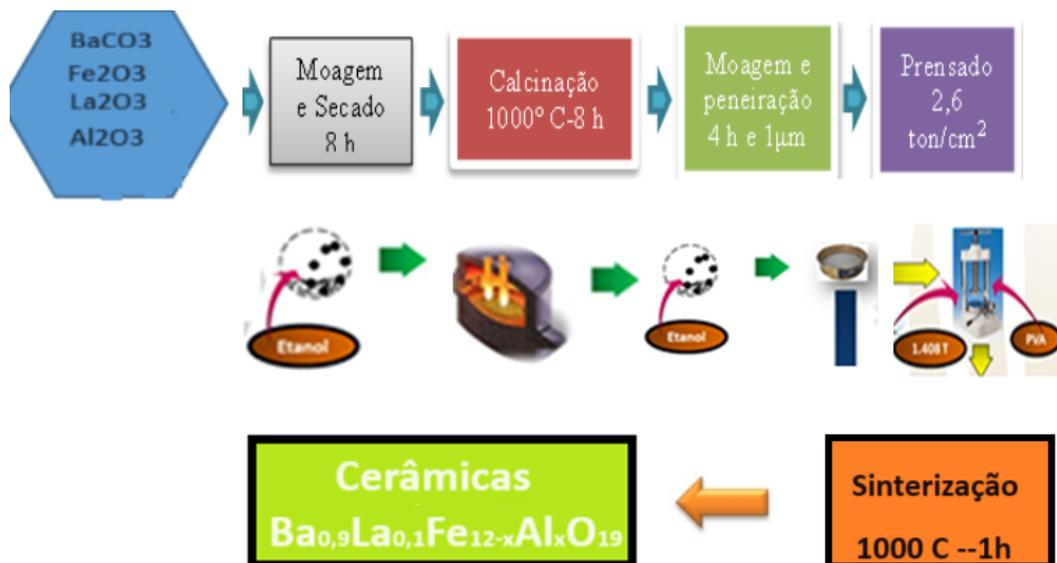
Figura 4.1: Esquema da rota de síntese usando o método cerâmico convencional. Fonte: Autor.
