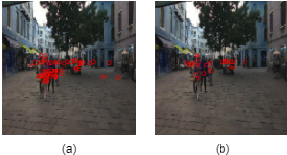
Figura 11 – Imagem (a) mostra as detecções sobre a imagem antes de aplicar o passo NMS. Imagem (b) mostra como as detecções ficam após aplicar o NMS.
