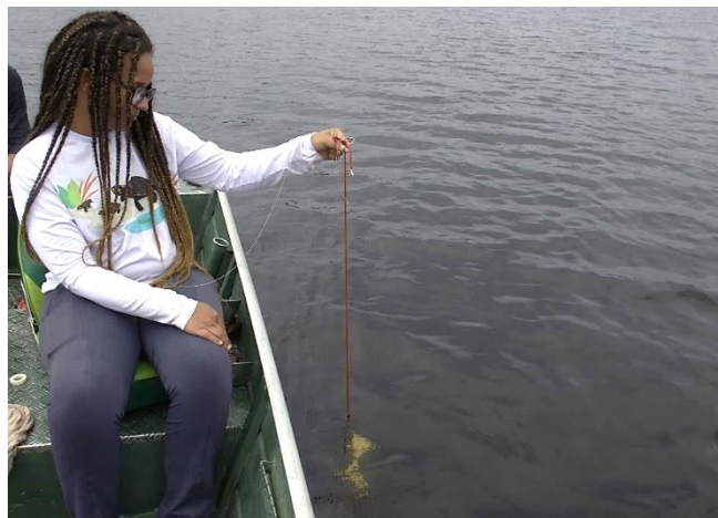
Figura 6 - Análise da transparência da água com disco secchi. Fonte: Marcelle Vasconcelos.
