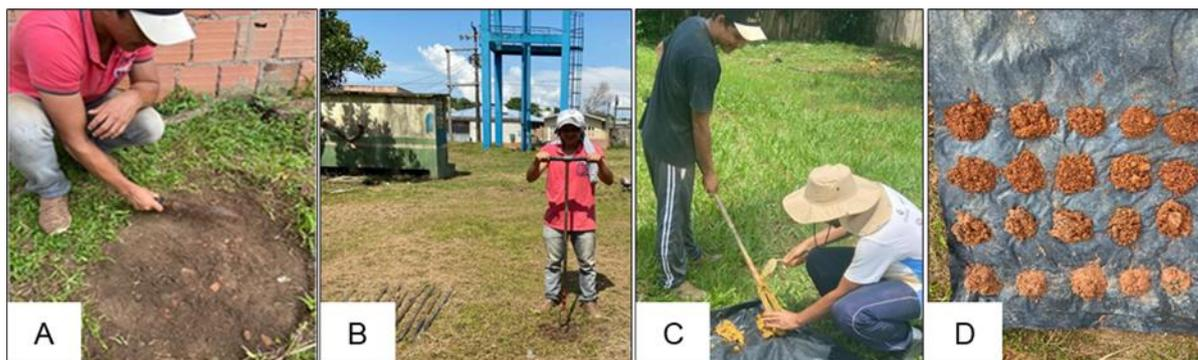
Figura 9: Coleta de amostras de sedimentos feita com o trado. A - Limpeza do terreno. B – Trado manual com caçamba. C - Amostras sendo retirada a cada 20 cm de profundidade. D - Sequências de amostras retiradas com trado (Fonte: Nascimento, W. B.).
