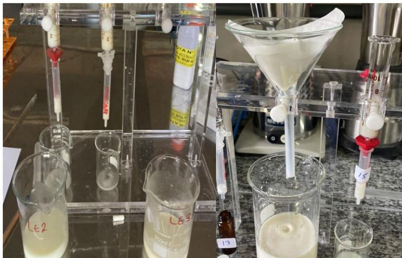
**Figura 3** – Extração do leite utilizando colunas de imunoafinidade.
