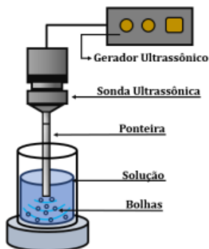
Figura 27. Ilustração de um gerador ultrassônico de ponteira. Fonte: Autor, 2024.
