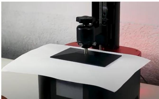
**Figura 24**– Nivelamento da impressora 3D. Fonte: (Autoria Própria)
