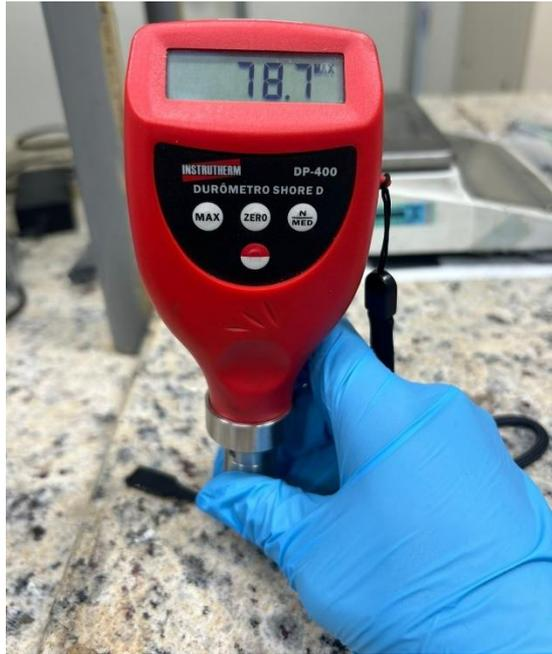
**Figura 29** – Durômetro Shore D utilizado para a medição da dureza do PLA puro e dos compósitos poliméricos (PLA+MCC) antes e após o envelhecimento térmico. Fonte: (Autoria própria)
