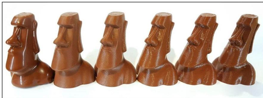
**Figura 18** – Teste de impressão com variação na altura da camada. Fonte: (3D LAB, 2022)
