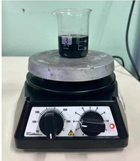
**Figura 23** – Agitador magnético. Fonte: (Autoria própria)
