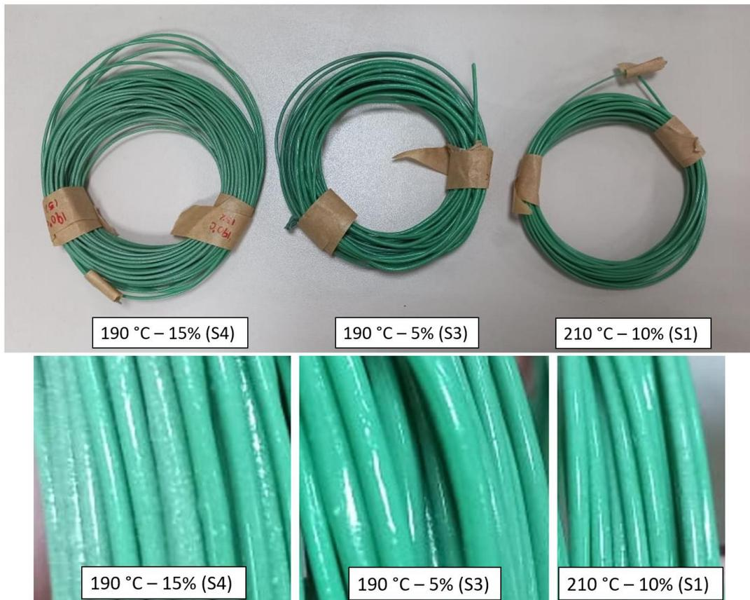
Figura 15: Filamentos de PLA+Hap, referente às composições S1, S3 e S4.
