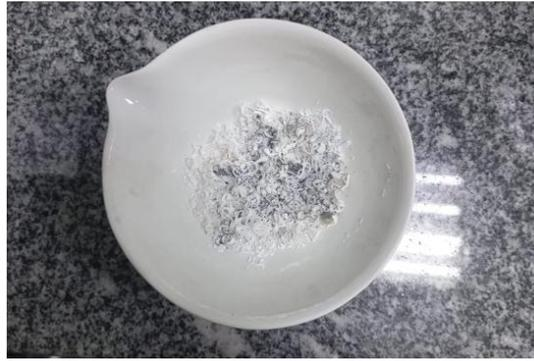
Figura 9: Escamas de Pirarucu após tratamento térmico de 700° C.
