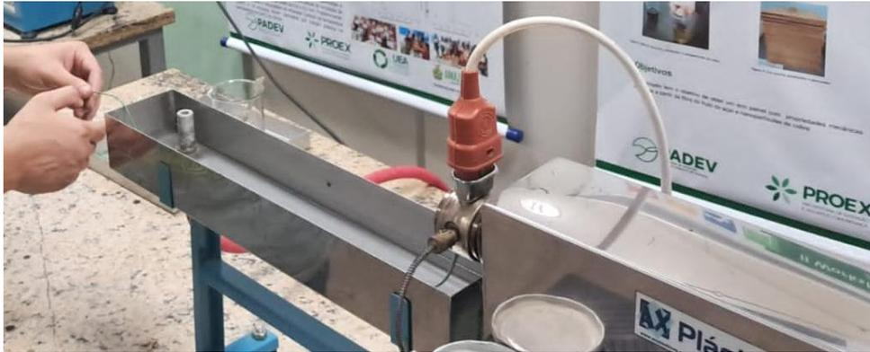
Figura 14: Fabricação de filamento de PLA+HAp (Resfriamento em água e temperatura ambiente).
