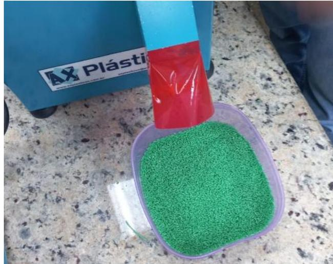
Figura 12: Pellets de PLA com dimensão média de 1,0 mm.
