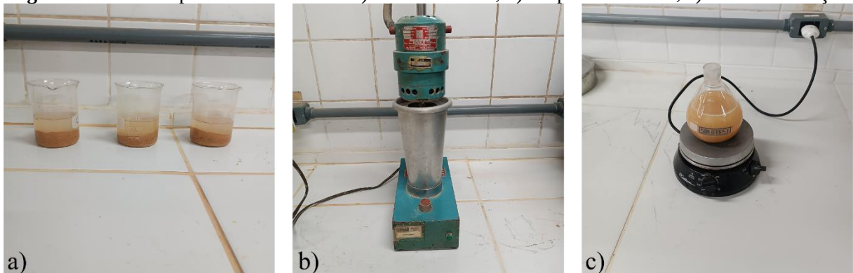
Figura 7 – Massa específica dos sólidos: a) Solo submerso; b) Dispersão do solo; c) Fase de Ebulição
