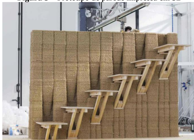
Figura 3 – Protótipo de parede impressa em 3D
