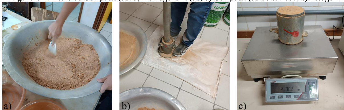
Figura 6 – Ensaio de Compactação: a) Homogeneização; b) Compactação de camada; c) Pesagem
