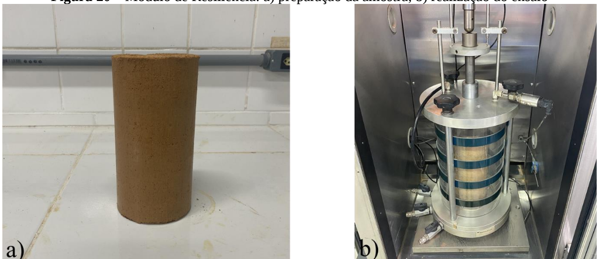
Figura 20 – Módulo de Resiliência: a) preparação da amostra; b) realização do ensaio
