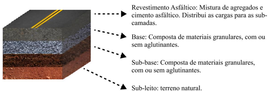
Figura 1 – Camadas de pavimento
