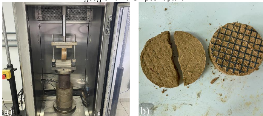
Figura 16 – Resistência à tração por compressão diametral: a) CP na UTM-100; b) detalhamento da geogrelha no CP pós-ruptura
