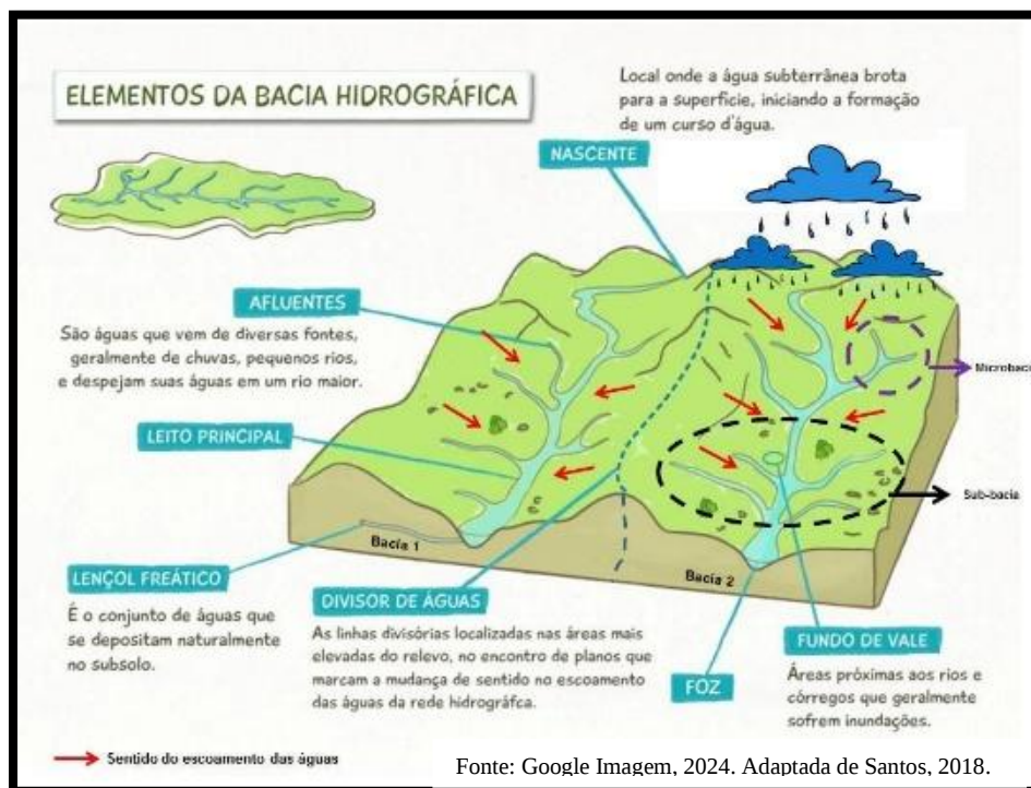
Figura 3 – Características e elementos constituintes de bacia hidrográfica
