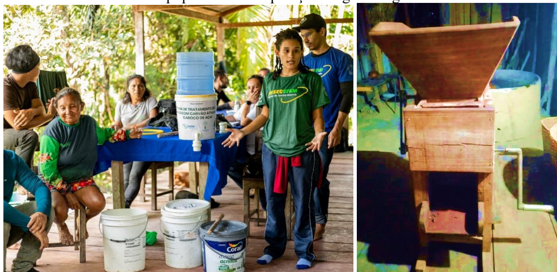
Figura 52 – Tecnologia Social – (A) Filtro de carvão ativado de caroço de açaí (B) Equipamento de separação do grão de guaraná
