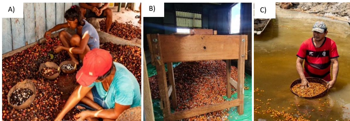
Figura 36. Processos de descasca e lavagem no Alto Urupadi. (A) descasca manual, (B) equipamento artesanal de descasca e (C) lavagem
