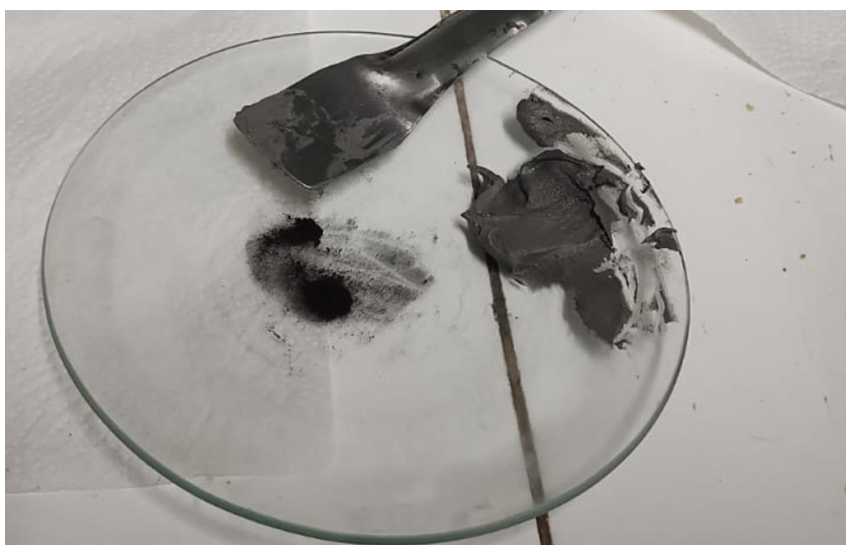
Figura 9: Misturas sendo preparadas de nanopartículas (pó preto) com a pasta de solda.
