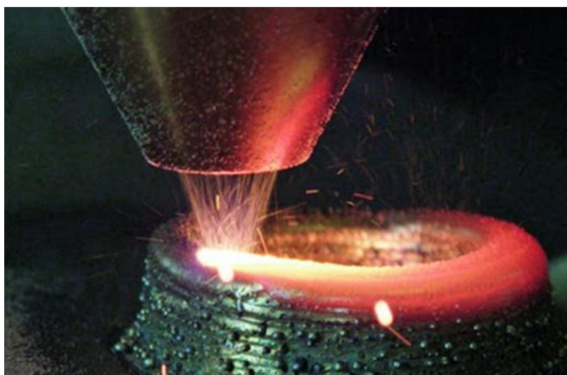
Figura 4. DED-L (Deposição de energia direta a laser). Fonte:hannaamt.com
