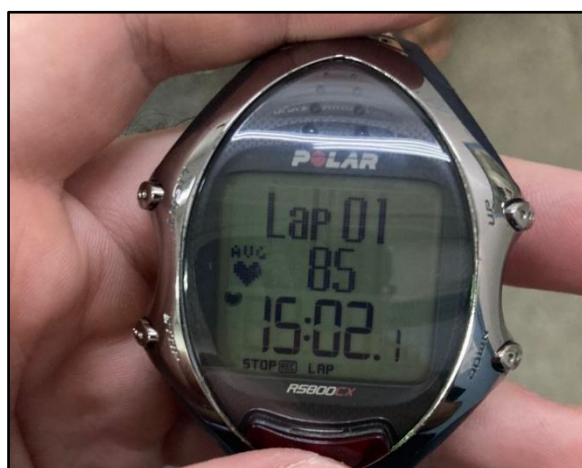
Figura 5 – Dispositivo não invasivo para análise da VFC – Polar RS800Cx
