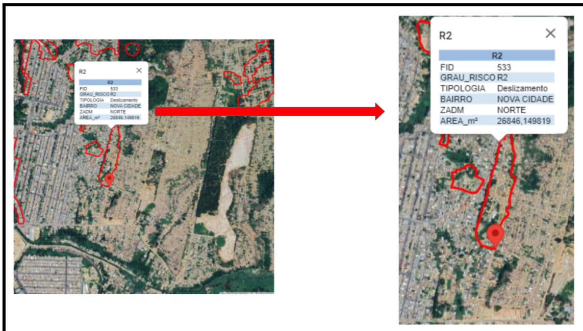
Figura 11: Grau e Tipologia de risco na Comunidade Buriti.
