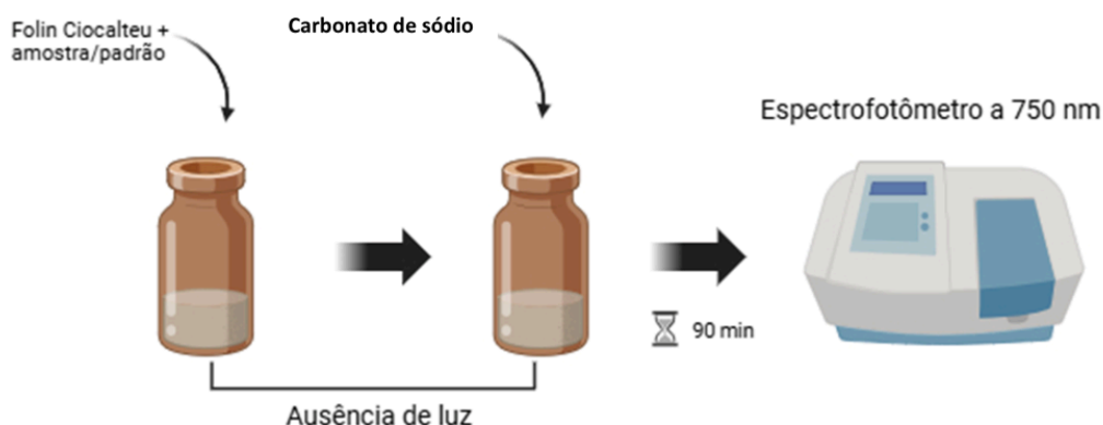
Figura 11. Esquema de análise da determinação de fenóis totais.
