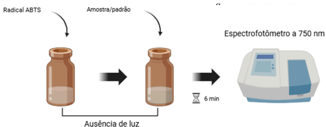
Figura 10. Esquema de análise do método de ABT•+
