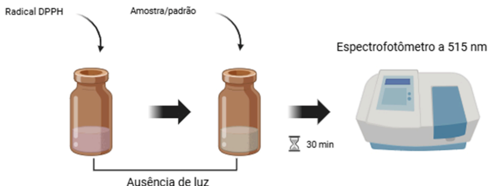
Figura 9. Esquema de análise do método de DPPH•
