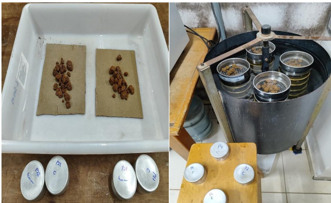
Figura 9: Umedecimentos e agitação dos agregados do solo em sistema Yoder.
