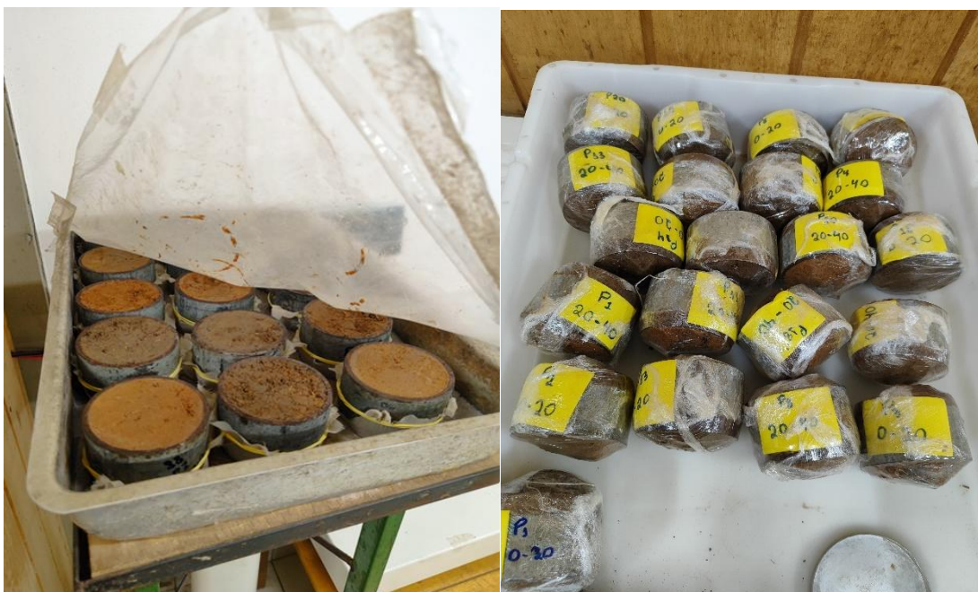
Figura 12: Análises físicas do solo pelo método do anel volumétrico em mesa de tensão.
