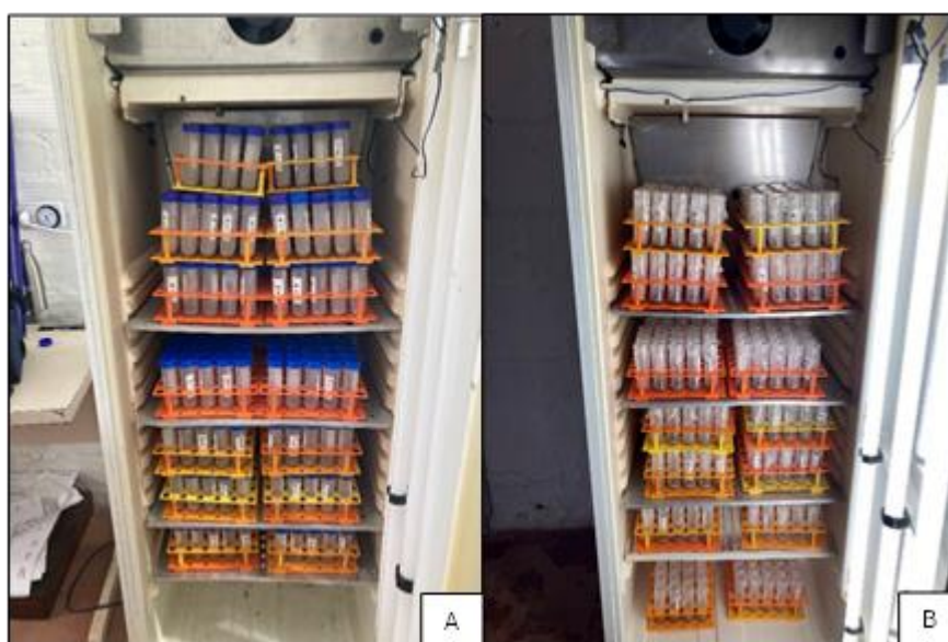
Figura 13. Disposição das amostras de solo em tubos falcons de 30 ml e incubação em BOD, Pelotas - RS, 2024.
