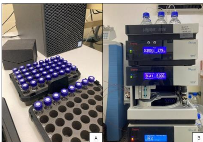
Figura 16. Rach de amostras e Equipamento de Cromatografia de Alta Performance (HPLC) do Laboratório de Dinâmica de Herbicidas, Pelotas – RS, 2024.
