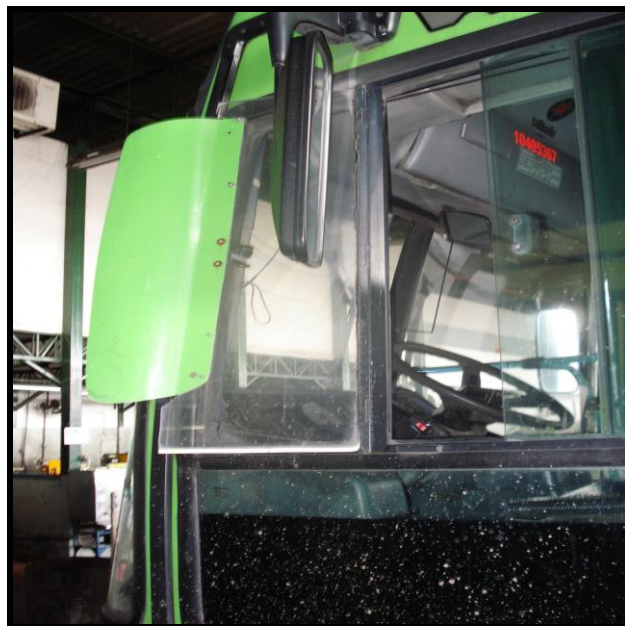
Figura 8 - Placa adaptada para entrada de vento
