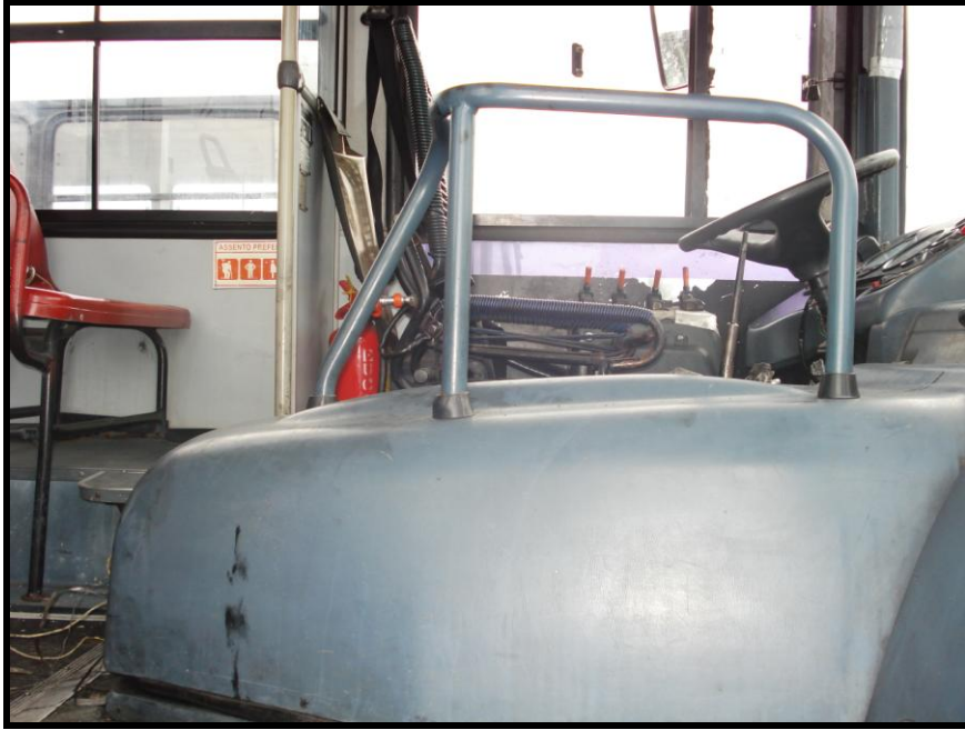
Figura 9 - Alguns ônibus ainda possuem motor próximo ao motorista.
