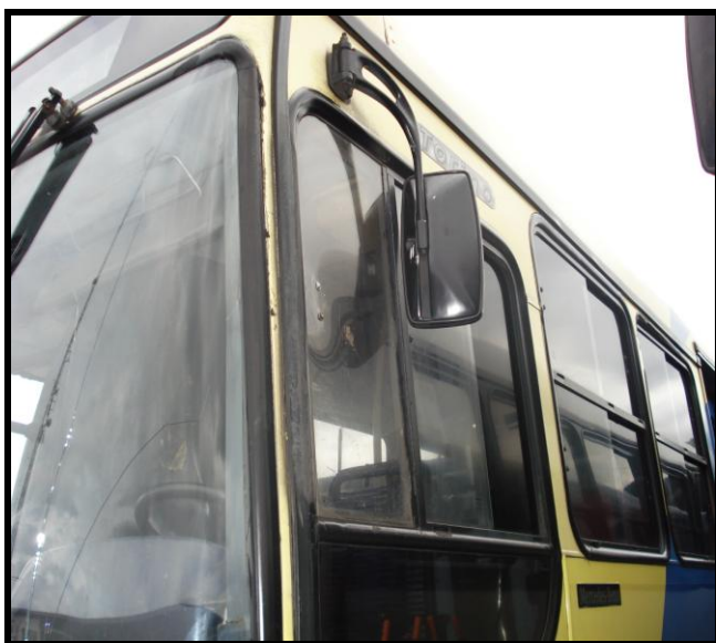
Figura 7 -Janela não proporciona ventilação
