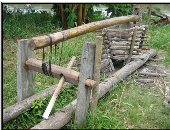
Figura 12 :Máquina de prensar mandioca FONTE: Francenilda Oliveira Fev/2007
