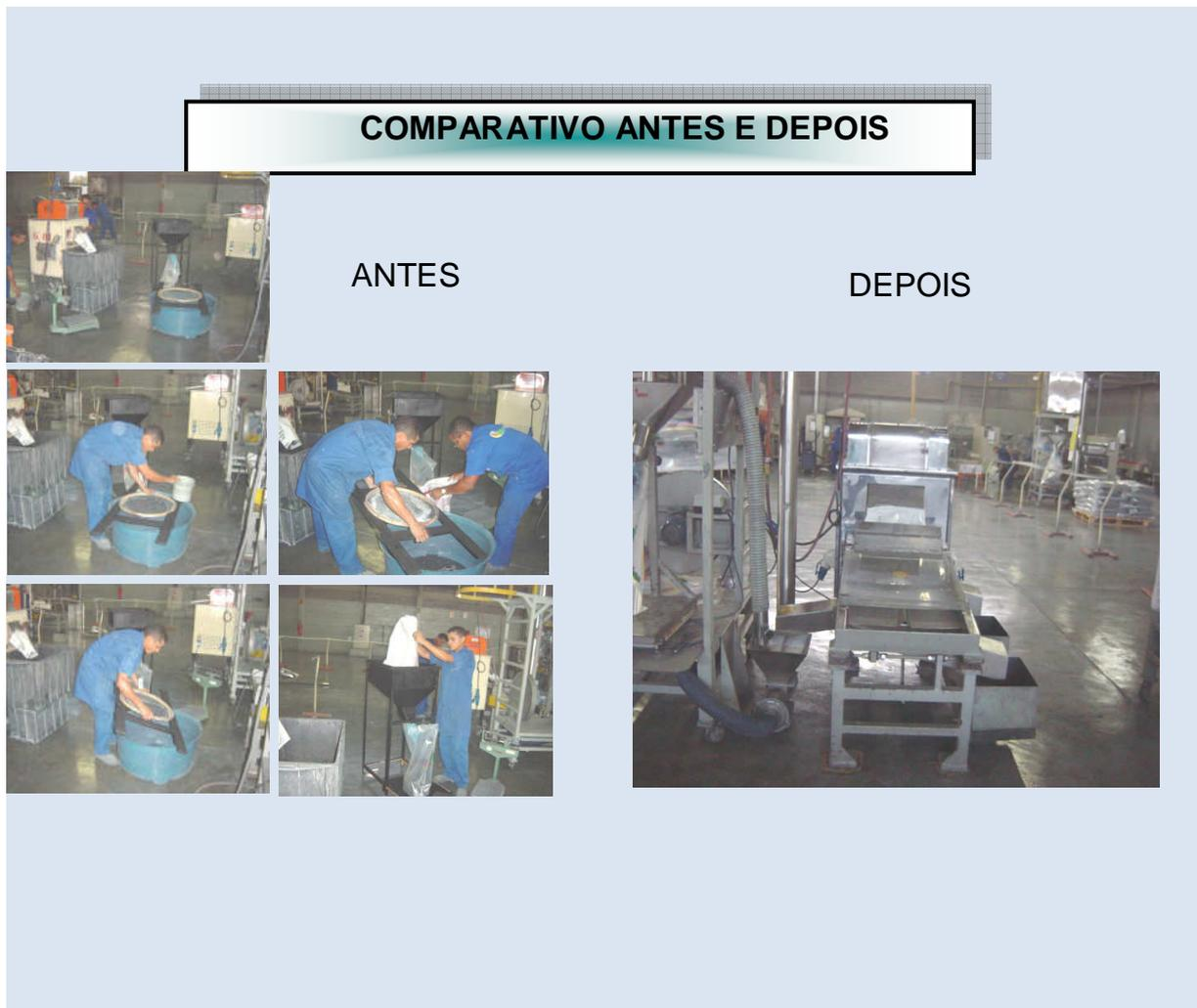
Figura 26. Automação do processo de embalagem
