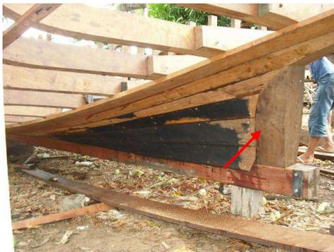
Figura 48 – Vista lateral da espinha de uma embarcação em madeira tipo regional
