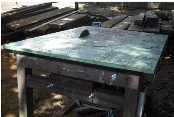
Figura 41 – Máquina serra circular
