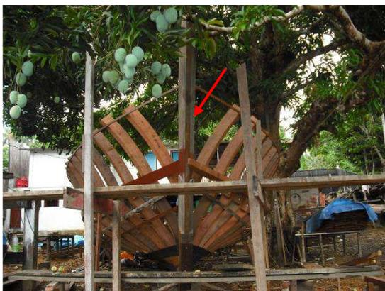
Figura 44 – Vista externa do talha-mar (embarcação em madeira)
