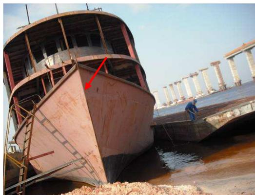
Figura 45 – Vista externa do talha-mar (embarcação em aço)
