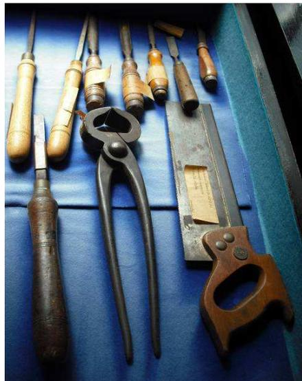
Figura 31 – Instrumentos – formão, torquesa e serrote (da esquerda para a direita)
