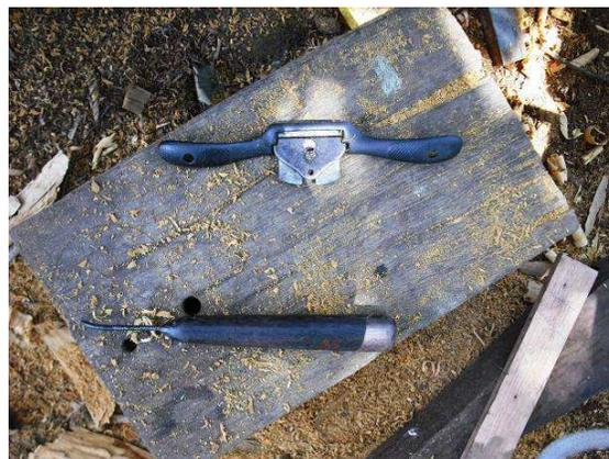
Figura 39 – Instrumentos – raspadeira (superior) e riscador (inferior)
