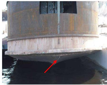
Figura 49 – Vista frontal da espinha de uma embarcação em aço tipo regional
