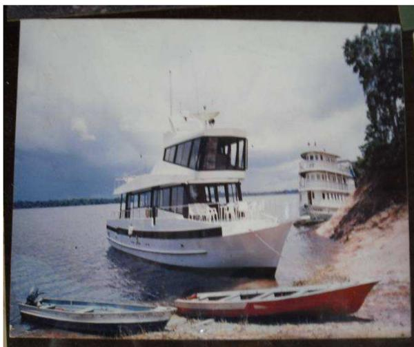
Figura 14 – Iate de passeio construído em madeira
