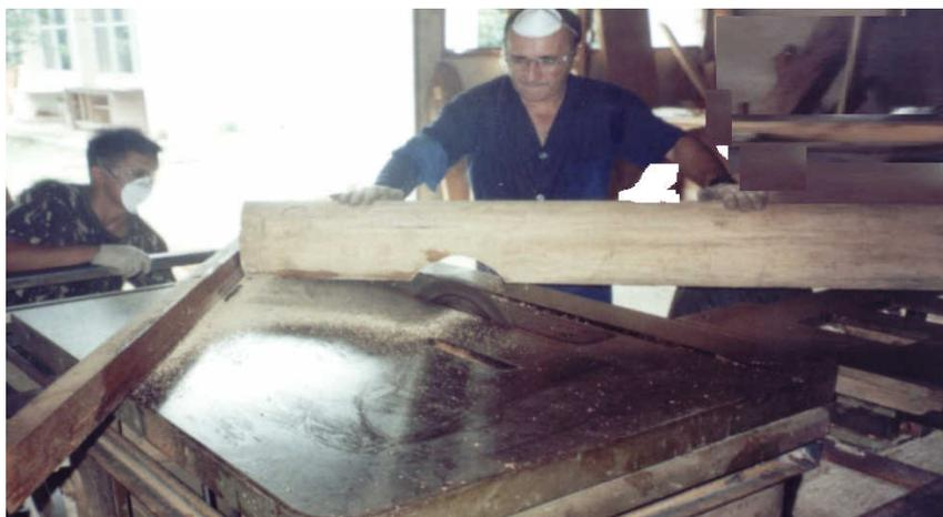
Figura 8. Confecção do encaixe da ponta do rolete em serra circular.
