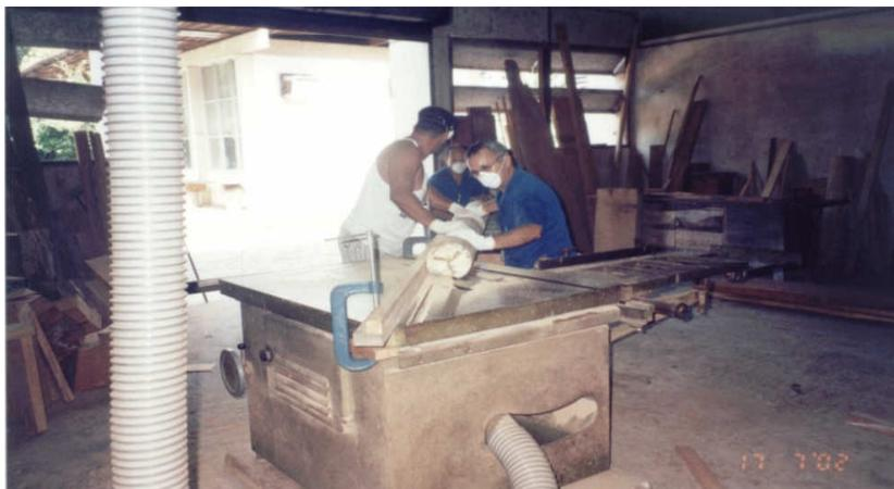
Figura 7. Confeção do rebaixe longitudinal do rolete em serra circular.
