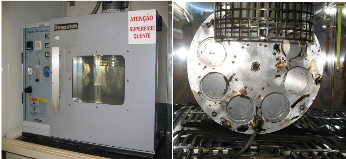
FIGURA 3.2 – Detalhe da Estufa de Filme Fino Rotativo (RTFOT).
